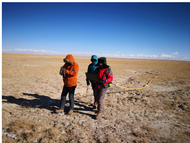
在可可西里盐湖下游多年冻土区进行地质雷达野外数据采集
