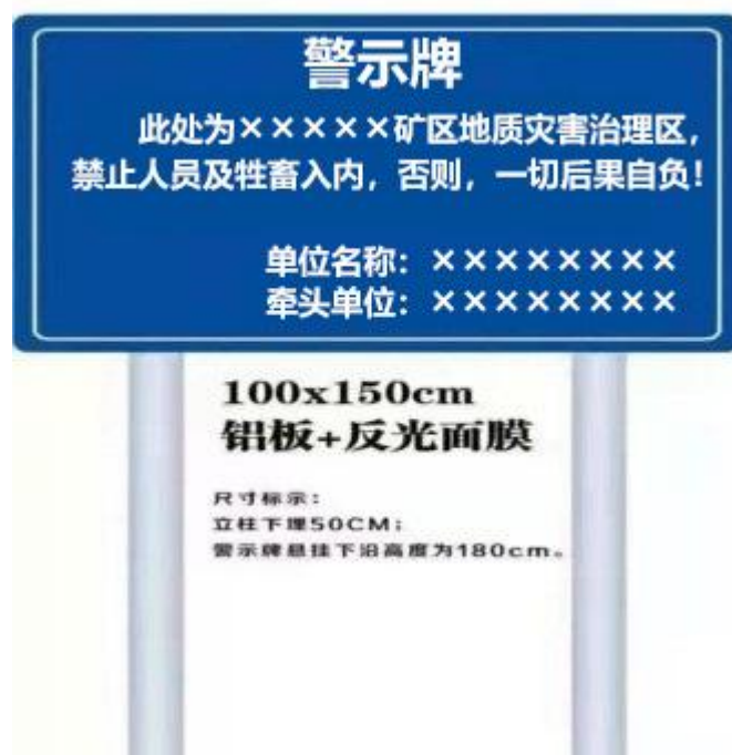
图5-1 警示牌结构设计示意图
