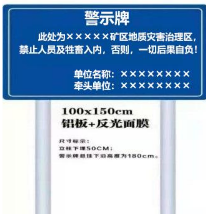
图 5-1 警示牌结构设计示意图
