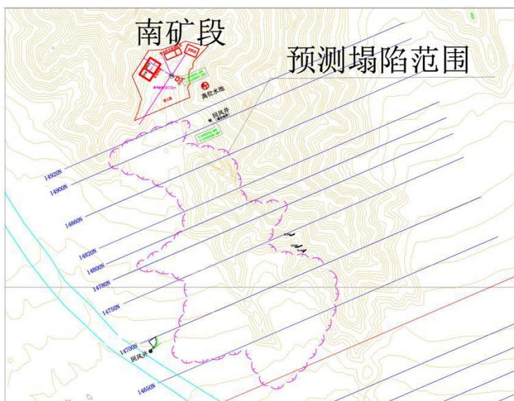
图 3-11 南矿段采空区预测塌陷范围图
