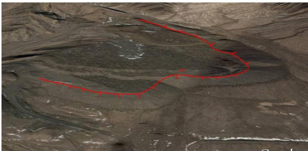
图 3-3 不稳定斜坡 Q<sub>2</sub> (北矿段东排土场) 卫星影像图
